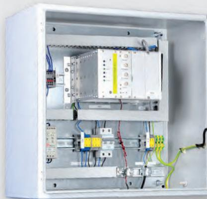
Das Prüfsystem wurde als Komplettsystem im Wandgehäuse realisiert – mit integriertem ICP-Verstärker und NI Single-Board RIO.
