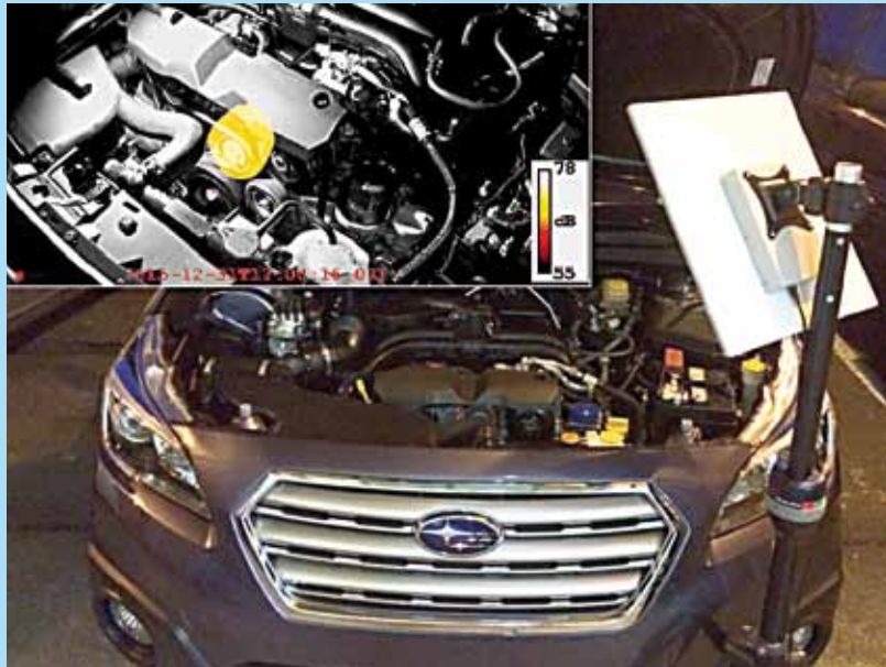
Ein Riemenschaden, detektiert mit der ACAM 120.
