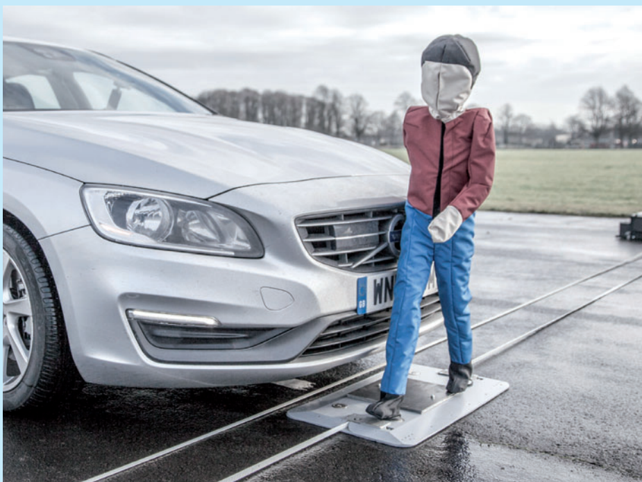
Häufig eingesetzt werden die automatisierten und synchronisierten Targets von Marktführer AB Dynamics.
