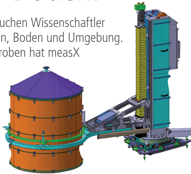
Auf dem Versuchsfeld in Selhausen: Die Lysimeter sind ringförmig um einen Serviceschacht angeordnet.
