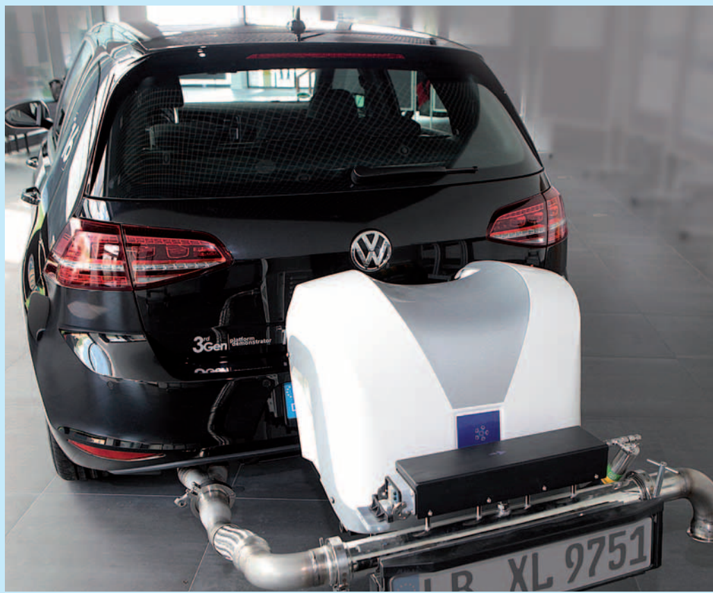
Auf dem Rollenprüfstand wird der genormte Neue Europäische Fahrzyklus (NEFZ) gefahren, um Verbrauch und Emissionen zu bestimmen. (Abbildung beispielhaft)
