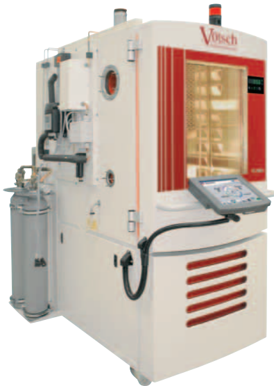
Im Klimaschrank kann bei Temperaturen von -40^{\circ} bis +80^{\circ} Celsius getestet werden. Foto: Vötsch Industrietechnik GmbH
