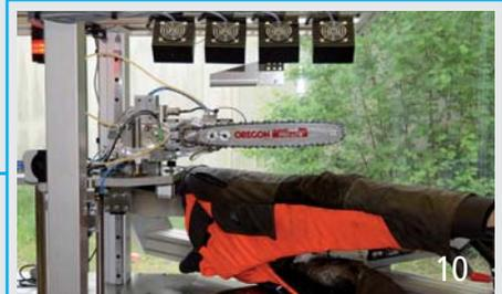
**Applikationen & Projekte – Prüfstand für Schnittschutzmaterialien.** Wer mit der Motorkettensäge arbeitet, braucht zuverlässige Schutzkleidung. Mit der Optimierung von Schnittschutzmaterialien beschäftigt sich die Hochschule für Forstwirtschaft Rottenburg. Gearbeitet wird dabei mit einem Prüfstand, der zusammen mit measX entwickelt wurde.
