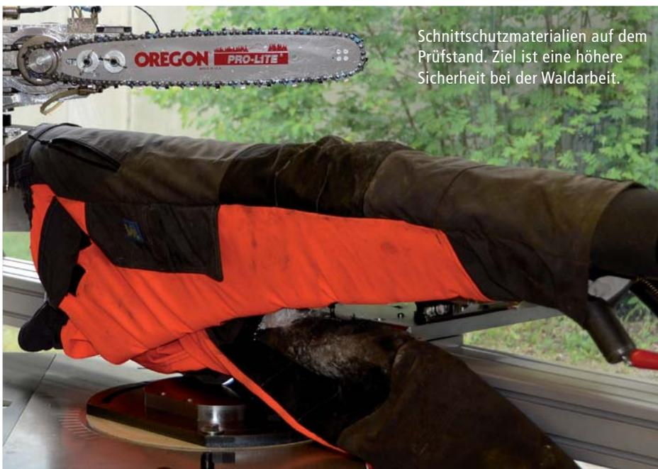
Schnitenschutzmaterialien auf dem Prüfstand. Ziel ist eine höhere Sicherheit bei der Waldarbeit.
