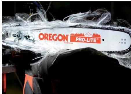
Das Fasermaterial der Schnitenschutzhose bringt die Sägekette zum Stillstand.
