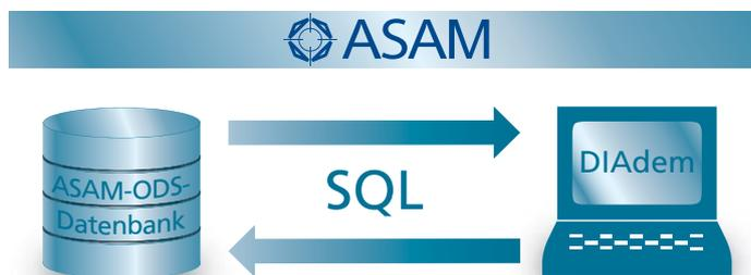
Die nach ASAM-Standard strukturierte Datenbank wird direkt über SQL angesprochen.
