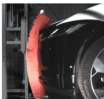
Bild 1 ((Test mit Beinprüfkörper aPLI, measX_leg-test_srcEuroNCAP.jpg ))
