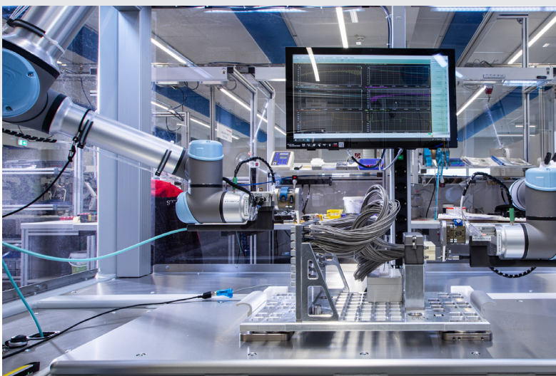
Hightech-Test mit Robotik: Zwei Roboterarme bringen die Messspitzen präzise in Position.
